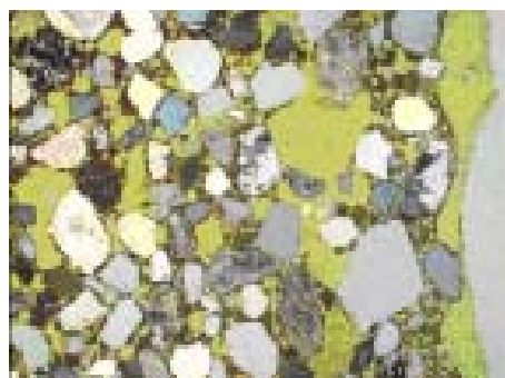
Snit i puds, som er blevet færdigbehandlet før materialet er blevet stift. Man ser et ydre lag af bindemiddel og større porer end i det øverste billede.
