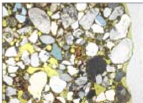
Snit i puds, som er færdigbearbejdet efter at materialet er blevet stift.
