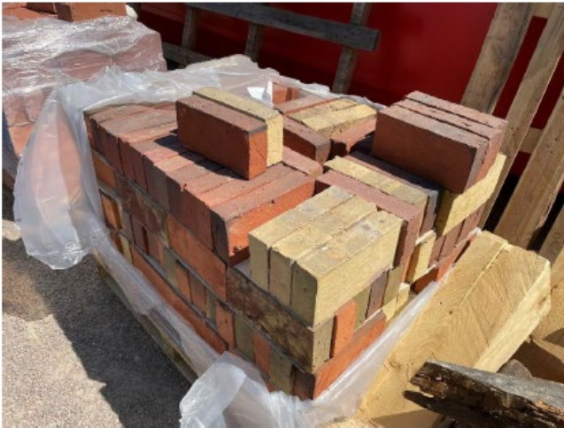
Specialtillverkat ersättningstegel för komplettering av befintligt återanvänt tegel vid lagning i tegelfasader samt ommurning av skorstenar.
