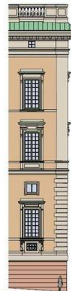
1898-1902 Kalkputsen genomfärgades ljusbeige. All stendekor ren- gjordes från färg och fick framträda med sin åldrade gulgrå färgton. Även stende- taljer som inte varit avsedda att se ut som sten rengjordes. (se stenen ovanför fönster, jämför med fasad t.v.) Fönstren som tidigare varit i ockra målades mörka.
