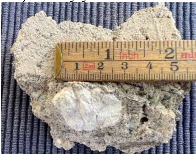
Store kalkkorn i mørtelen indikerer mørtel lesket på plassen med stykkalk.
