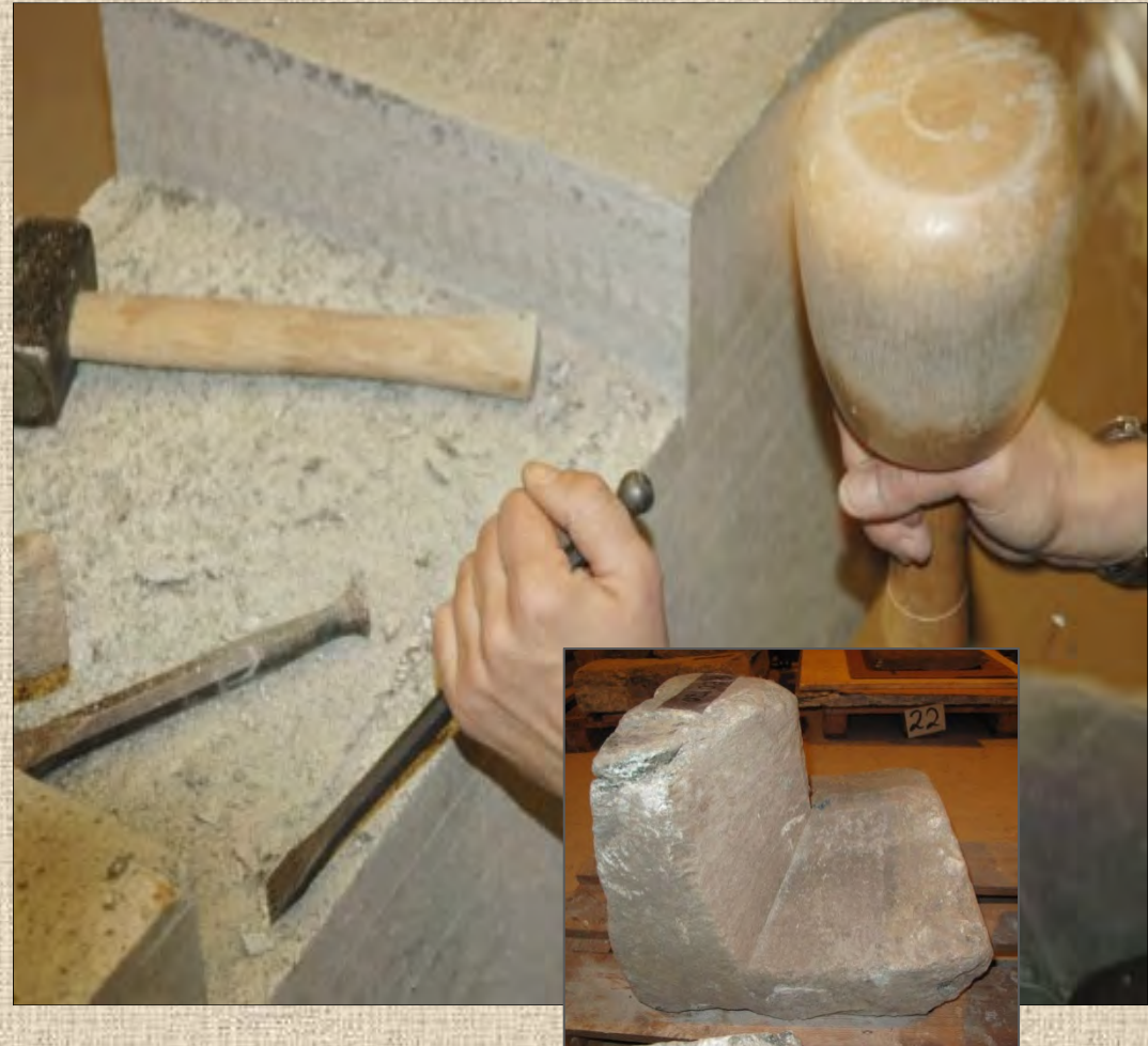
Målestreker er linjer i steine som ble risset innfor å se hva som skal hogges bort.
